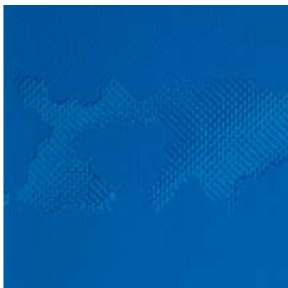
PVC素材上での 水系塗料の濡れ不良
