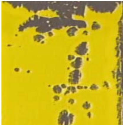
油分で汚染された下地への 濡れ不良
