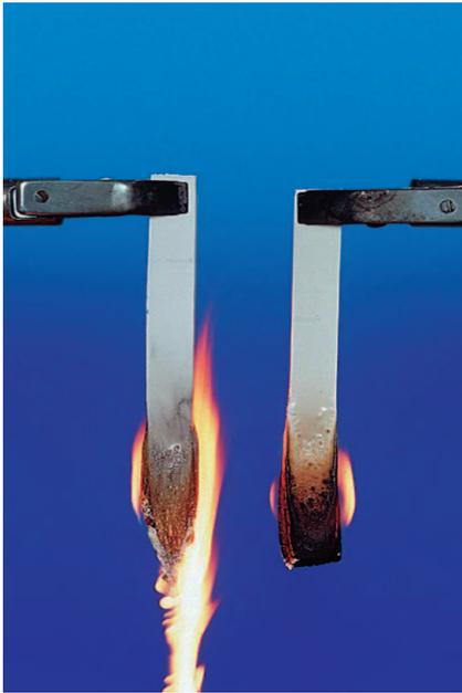
ケーブルが燃焼中には、この3次元ネットワークは強い炭素皮殻を形成し、あたかも断熱材のような役割を果たします。熱分解ガスの着火までの時間が増加します。そのため、炎の遅延試験では、はるかに少ない水酸化物量レベルで合格することができます。
